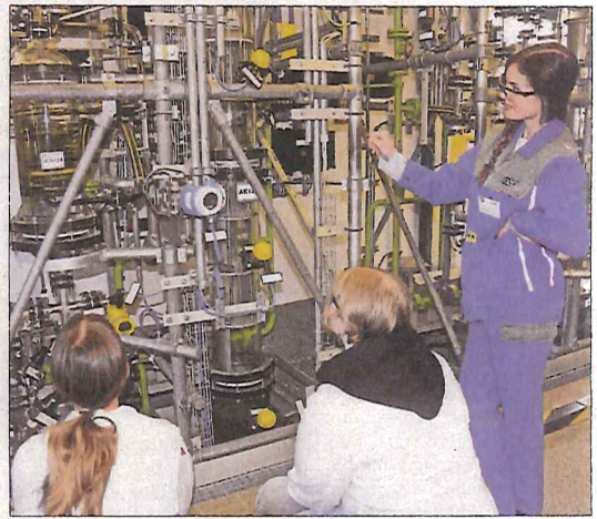
Bei Wacker erklärte Auszubildende Janine Sommerfeld den Schülerinnen unter anderem eine Destillationsmaschine, in der ein Ethanol-Wasser-Gemisch thermisch getrennt wird.
